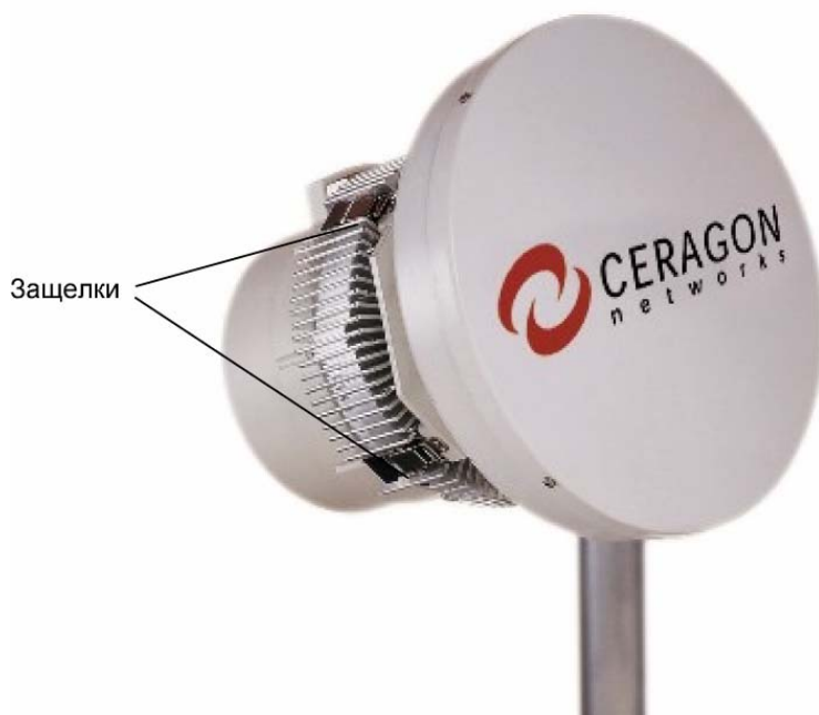
ODU, установленный на антенне
